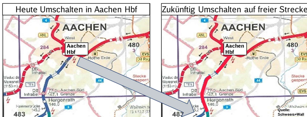
Abbildung 21: Verlegung der Systemtrennstelle von Aachen Hbf auf die Strecke Richtung Liège
